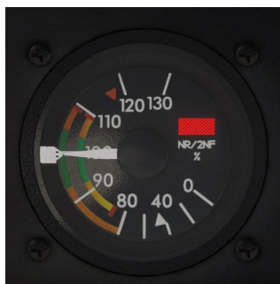
Dreifach-Drehzahlanzeige (NR, N2 für jeden Motor) mit roter Fehleranzeige
